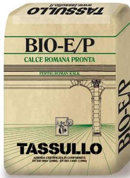
**BIO-E/P** è una malta pronta di calce idraulica naturale BIO-E e inerti dolomitici con curva granulometrica selezionata e granulometria massima di 4 mm adatta al confezionamento di malte da rinzafo e intonaco tradizionale, riempimento tracce, tamponatura.
